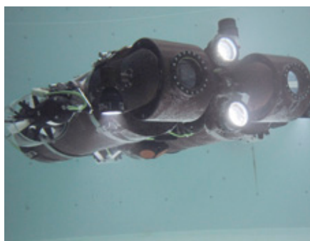
Dagon ist ein autonomes Unterwasserfahrzeug, das für die visuelle Kartenerstellung von Meeresböden und zur Lokalisierung konzipiert wurde. In seinen beiden Köpfen ist ein schwenkbares Stereokamerasystem untergebracht, das auch bei Inspektionen einsetzbar ist. Foto: DFKI GmbH
