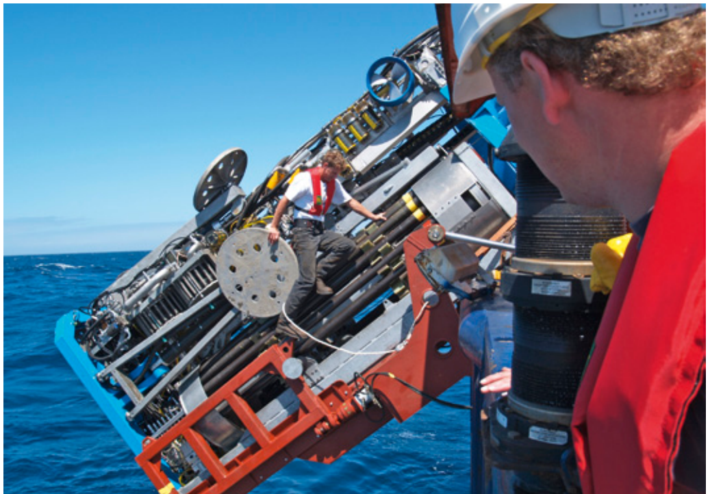
Das 90 Tonnen schwere Bohrgerät „MeBo“ ermöglicht es, Proben unabhängig von einem Bohrschiff zu entnehmen. Foto: MARUM
